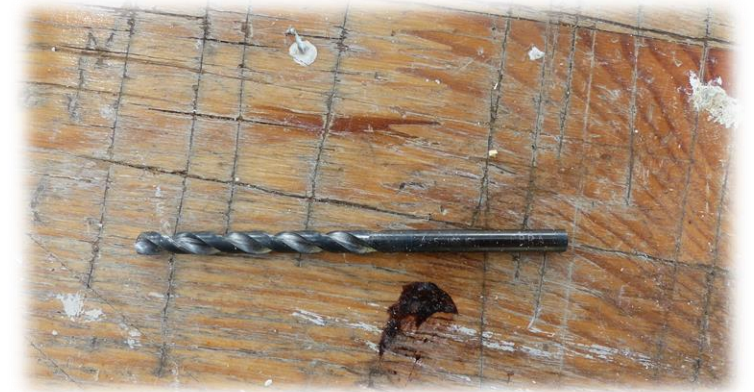
4er Bohrer + 3.8er Bohrer (geeignet für Alu und Stahl)
